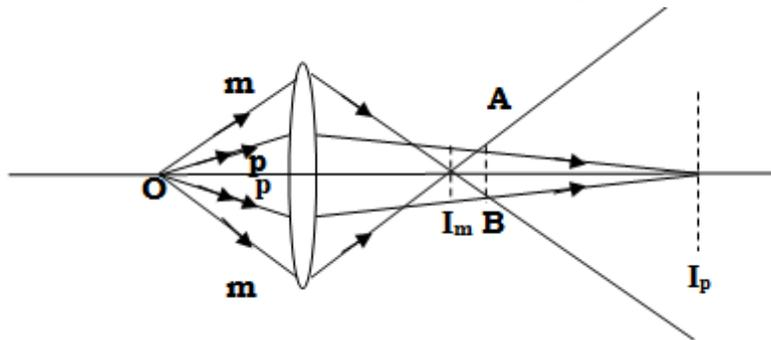
**METHODS TO MINIMIZE SPHERICAL ABERRATION:**
